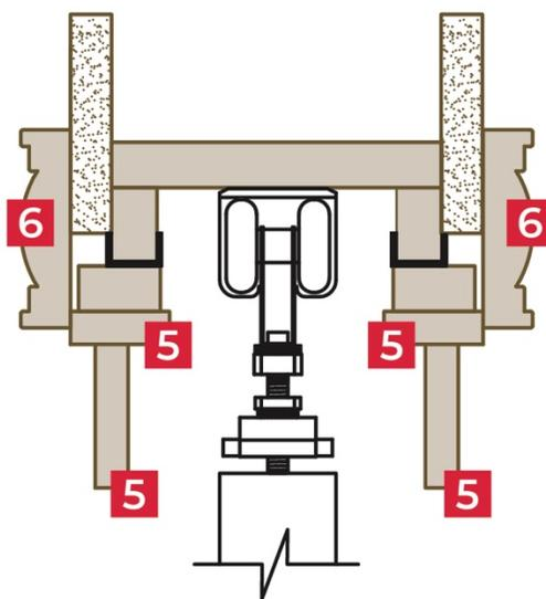
**Attention :** Si le gypse à une épaisseur de plus de 1/2" (12,7 mm), les moulures de finition **5** doivent être à égalité avec le gypse pour faciliter l'installation des chambranles décoratives **6** voir exemples avec gypse 5/8".
