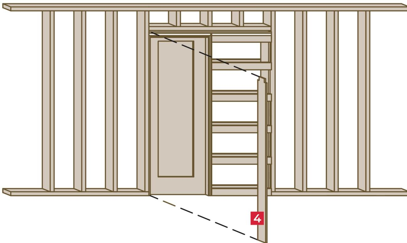
E. Fixer au cadre les morceaux de finition (sur les montants du cadre escamotable).
