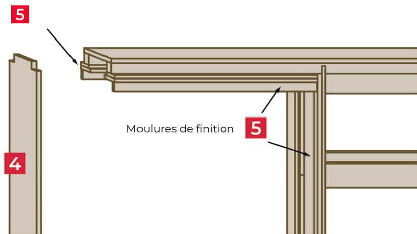
**Note :** Ne pas installer de moulures de finition **5** sur la planche **4**.
