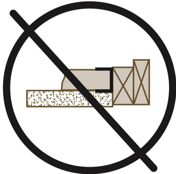
Appliquer le panneau de gypse sur les traverses de bois du cadre escamotable, ensuite fixer la chambranle de finition.
